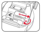
MARNING NEVER LEAVE THE BATTERIES INSIDE THE MOWER WHEN MOWER IS NOT IN USE.
