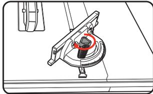
**WARNING!** DO NOT PUSH THE MITRE GAUGE STOP RAIL TOO FAR TOWARD THE BLADE. THE DISTANCE BETWEEN THE STOP RAIL AND THE BLADE SHOULD BE APPROXIMATELY 20MM.
