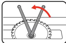
**WARNING!** TURN THE BLADE BOLT IN THE DIRECTION OF ROTATION OF THE SAW BLADE.
