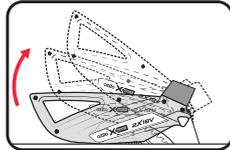
**WARNING!** THE BLADE GUARD MUST ALWAYS BE LOWERED OVER THE WORK PIECE AND MOUNTED SECURELY BEFORE YOU BEGIN TO CUT.
