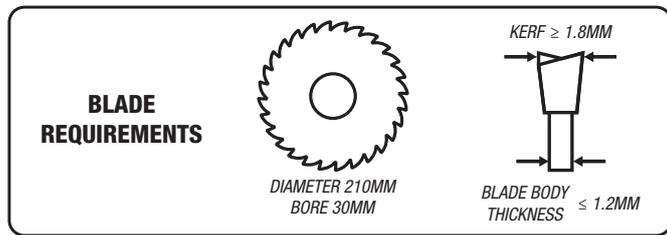
**WARNING!** ENSURE THAT THE SAW BLADE IS SUITABLE FOR THE MATERIAL TO BE CUT AND THAT THE MAXIMUM POSSIBLE SPEED IS MORE THAN THE MAXIMUM TOOL SPEED.
