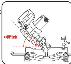
**WARNING!** ENSURE THE FENCE IS CLEAR OF THE BLADE BEFORE BEVELLING.
