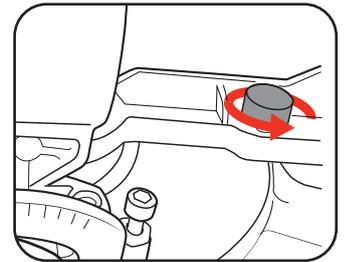
2. Rotate the mitre table to the desired mitre angle using the mitre angle scale.
