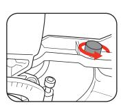
2. Rotate the mitre table to the desired mitre angle using the mitre angle scale.
