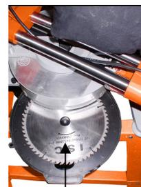
praktische Sägeblattablage auf der Geräterückseite
