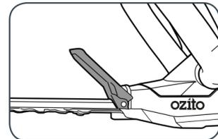
**WARNING!** NEVER USE THE HEDGE TRIMMING UNLESS THE SAFETY GUARD IS FITTED.
