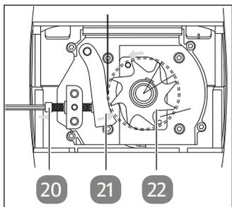
Gegenmesser **21** und Messerwalze **22** sind vom Werk optimal justiert. Nur bei Abnutzung ist eine Nachjustierung des Gegenmessers bei eingeschaltetem Motor erforderlich. Für einen optimalen Betrieb ist es nötig, dass der Abstand zwischen Gegenmesser und Messerwalze ca. 0,50 mm beträgt. Auf der rechten Seite des Kunststoffgehäuses befindet sich hierzu der Knauf **9** zur Gegenmessereinstellung.
