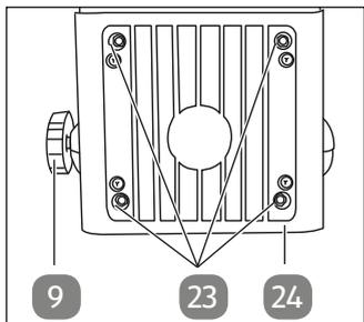
5. Lösen Sie die vier Innensechskantschrauben **23** vollständig.
