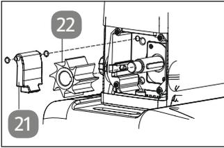
8. Entfernen Sie Gegenmesser **21** und Messerwalze **22** und überprüfen Sie beides.
