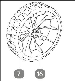
3. Stecken Sie jeweils eine Schraube des Schraubensatzes **16** mit einer Beilagscheibe des Schraubensatzes von der Radseite mit den Stegen her durch die Buchse.
