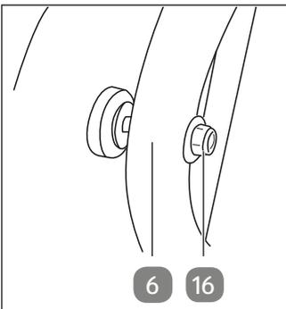
4. Verschrauben Sie die Räder mit dem Untergestell **6**. Legen Sie dabei je eine Beilagscheibe des Schraubensatzes **16** vor und nach dem Untergestell unter. Ziehen Sie die Sicherungsmuttern des Schraubensatzes mit den Gabelschlüsseln **15** nur soweit fest, dass sich die Räder noch leicht drehen lassen.
