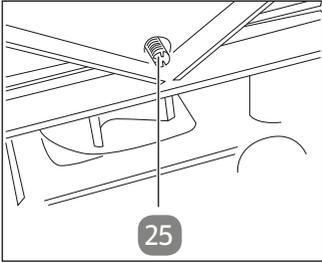
6. Lösen Sie die Sicherungsschraube **25** an der Unterseite des Gartenhäckslers bis zum Anschlag.
