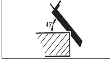
Kenarların 45- açı ile hızlı ve kolayca kırılması için, ön temel plaka üzerinde oluşturulmuş olan V-oluğunu kullanın. Rendeyi V-oluğu ile, işlenecek kenarın üzerine oturtun ve bu kenar üzerinde hareket ettirin. Bu işlem esnasında ilerlemenin düzenli olmasına ve açı pozisyonunun aynı kalmasına dikkat edin.
