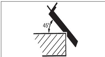
Ταχύ και εύκολο τελείωμα γωνιών 45 μοιρών με το αλτάκι που διαθέτει η εμπρόσθια βάση σε σχήμα V. Τοποθετήστε την πλάνη με το αλτάκι σε σχήμα V επάνω στην κατεργαζόμενη γωνία και οδηγήστε το κατά μήκος της γωνίας σπρώχνοντας την πλάνη ομοιόμορφα και σε σταθερή γωνία.
