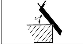
Ταχύ και εύκολο τελειώμα γωνιών 45 μοιρών με το αλτάκι που διαθέτει η εμπρόσθια βάση σε σχήμα V. Τοποθετήστε την πλάνη με το αλτάκι σε σχήμα V επάνω στην κατεργαζόμενη γωνία και οδηγήστε το κατά μήκος της γωνίας σπρώχνοντας την πλάνη ομοιόμορφα και σε σταθερή γωνία.
