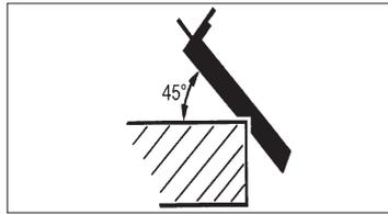
Szybkie i proste ścinanie krawędzi pod kątem 45° możliwe jest dzięki dopasowanemu do przedniej płyty podstawowej rowkowi V. Strugarkę z rowkiem V nasadzić na daną krawędź i prowadzić wzdłuż po jego powierzchni, przy czym zwrócić uwagę na równomierne przesuwanie i jednakowe położenie kąta.
