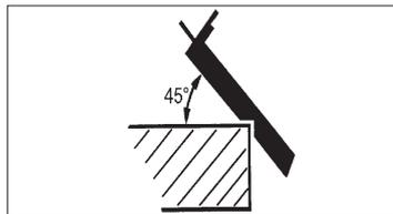
Быстрое и простое снятие фаски с кантов под углом 45° возможно при помощи сделанного в передней опорной пластине V-образного паза. Установить рубанок V-образным пазом на обрабатываемый кант и вести его вдоль, при этом необходима обеспечить равномерное продвижение и неизменный угол положения рубанка.
