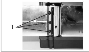
Wbudowanie noży następuje w odwrotnej kolejności. Proszę upewnić się, czy położenie noża jest prawidłowe w stosunku do obu końców wału. Należy wymienić jednocześnie oba noże, aby zapewnić jednaki odbiór wiórów.
