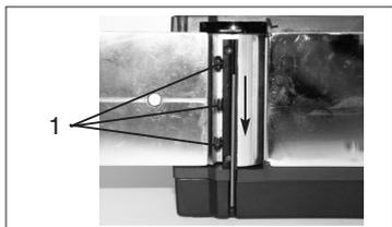
Slăbiți cele trei șuruburi cu cap hexagonal (1) cu cheia fixă alăturată și împingeți lateral cuțitul reversibil din aliaj dur cu o piesă de lemn în afara axului rindelei.
