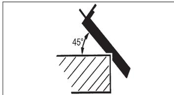
O teșire rapidă și simplă a muchiilor în unghi de 45° este posibilă prin canelura V încrustată în placa de bază frontală. Așezați rindeaua cu canelura V pe muchia de prelucrat și conduceți rindeaua de-a lungul muchiei. În acest caz trebuie să aveți în vedere un avans regulat și o poziție constantă de unghi.
