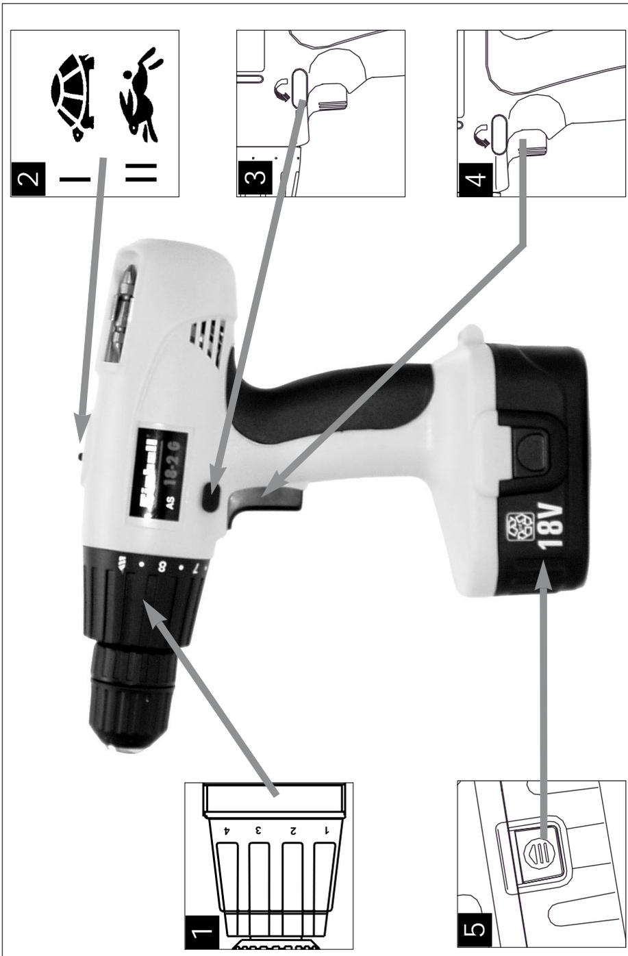
**D****Geräteabbildung:****Bild 1: Drehmomenteinstellung****Bild 2: Bithalterung****Bild 3: Umschaltung Links-Rechtslauf****Bild 4: Ein-/Ausshalter****Bild 5: Wechselakku, zur Entnahme des Akku-Packs beide Rasttasten drücken****Wichtige Hinweise:**
