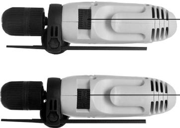
Schiebeschalter in Stellung Schlagbohren. **Nur im Stillstand umschalten!**
