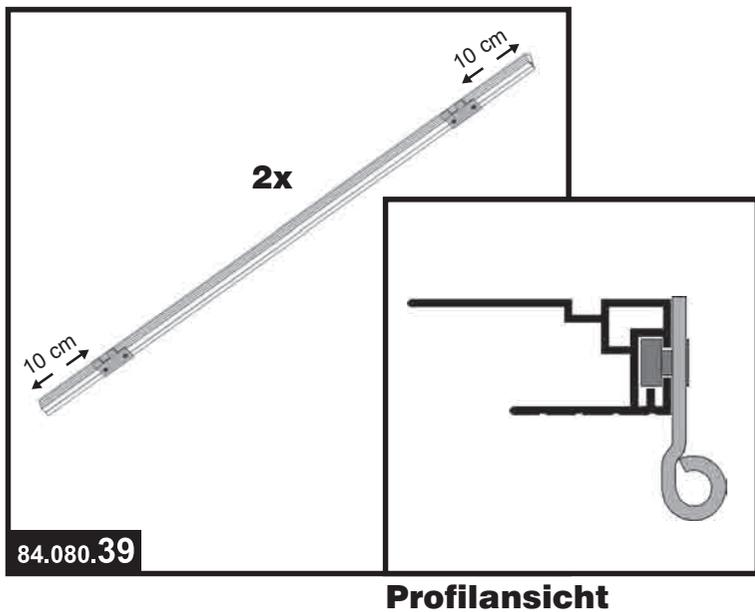
30/e An zwei Türprofilen Seite / kurz (Pos. 10) werden Scharnierflügel befestigt (vgl. Detailansicht). Montieren Sie an beide Enden des Türprofils Seite je einen Scharnierflügel zirka 10 cm vom Rand entfernt. Achten Sie darauf, dass Sie die Scharnierflügel wie in der Profilsansicht dargestellt einsetzen.
