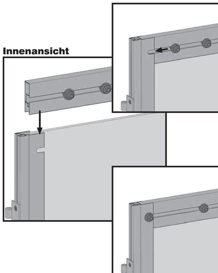
**30/n** Stecken Sie das Türabschlussprofil mit sechs vormontierten Schrauben (vgl. Schritt **30/c**) oben auf die beiden Türprofile Seite und die Stegplatte. Lockern Sie die äußeren Schrauben rechts und links am Abschlussprofil und schieben sie in die entsprechenden Aussparungen. Ziehen Sie die Muttern wieder fest.
