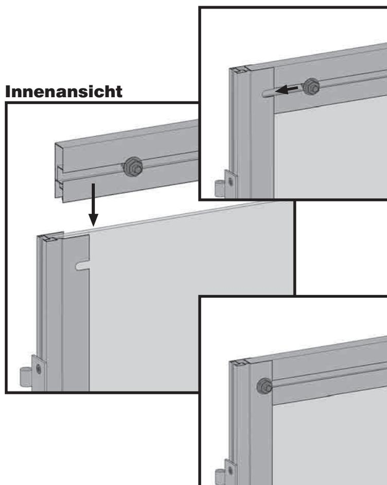
**30/j** Stecken Sie ein Türabschlussprofil mit zwei vormontierten Schrauben (vgl. Schritt **30/b**) oben auf die beiden Türprofile Seite und die Stegplatte. Lockern Sie die beiden Schrauben am Abschlussprofil und schieben sie in die entsprechenden Aussparungen. Ziehen Sie die Muttern wieder fest.
