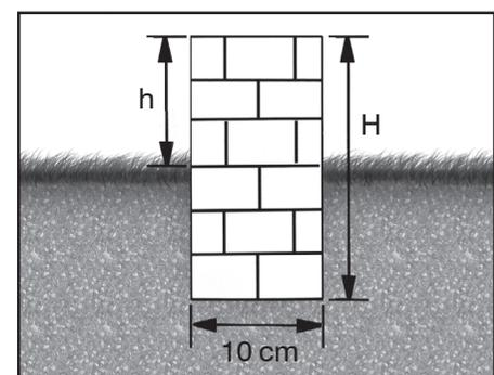
Das Fundament muss **mindestens 10 cm breit (T) und nach Bedarf (h) hoch** sein! Das Fundament muss im **rechten Winkel** und in der Waagrechten stehen.
