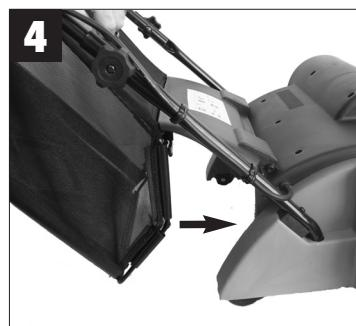
④ Montage des Fangsackes (Abb. 1-4):
