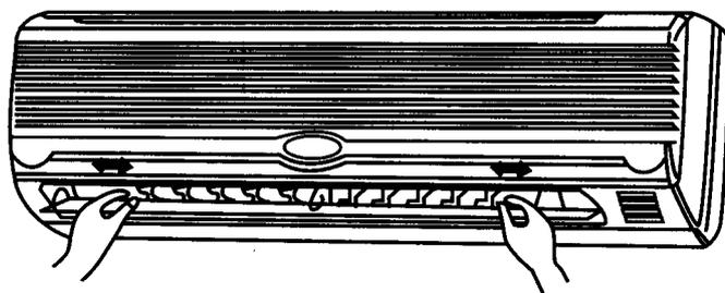
La direction du courant gauche et droite peut être réglée manuellement.
