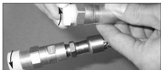
3. Placez les conduites de réfrigérants de sorte qu'elles sont raccordées aux soupapes sans tension. Posez le raccord vissé de la conduite de réfrigérant en position droite sur le filet de l'appareil extérieur et vissez les premières spires manuellement.
