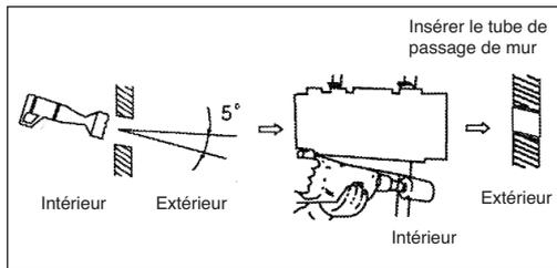
**3.4 Monter le tuyau d'écoulement de l'eau condensée**
