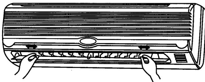
Die linke und rechte Strömungsrichtung kann manuell eingestellt werden.
