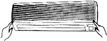
Ziehen Sie an den unteren Ecken des Ansauggitters. Das Gitter klappt auf (ca. 25°) und bleibt in dieser Position.
