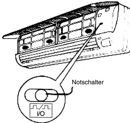
Dieser Schalter kann als Notschalter zum Ein-/Aus-schalten der Anlage verwendet werden, falls die Fernbedienung nicht mehr funktioniert.
