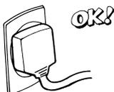
Lose Stecker und beschädigte Stromkabel können Ausbrennen oder Kurzschluss zur Folge haben und sind äußerst gefährlich.
