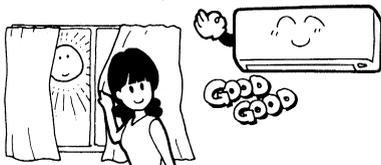
Während des Kühlbetriebes sollte direkte Sonneneinstrahlung durch Vorhänge oder Rollläden vermieden werden. Die Fenster und Türen sollten ausser beim Lüften stets geschlossen bleiben..
