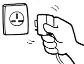
Den Betrieb niemals durch Einstecken oder Herausziehen des Netzsteckers starten bzw. stoppen, da dies gefährlich ist.
