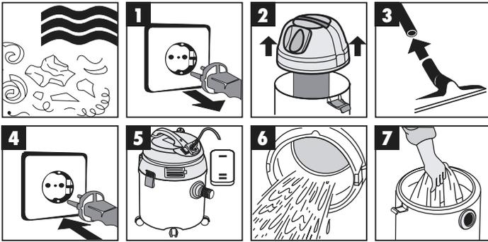
Ⓢ Zum Naßsaugen ziehen Sie den beiliegenden Schaumstofffilter über den Filterkorb (Bild 2). Der bei der Lieferung bereits montierte Faltenfilter ist nicht für das Naßsaugen geeignet!
