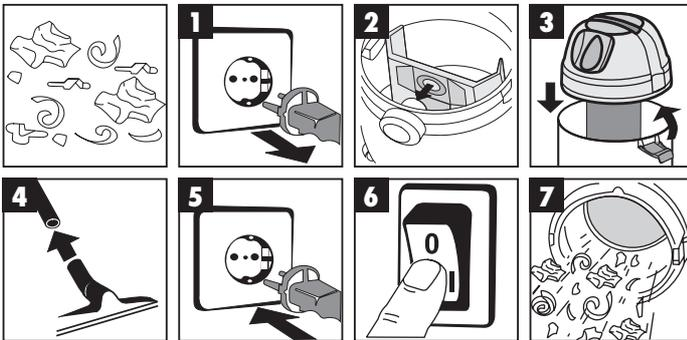
Ⓢ Zum Trockensaugen schieben Sie den Schmutzfangsack (Bild 2) auf den Stutzen. Der Schmutzfangsack ist nur für das Trockensaugen geeignet!
