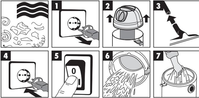
Ⓢ Zum Naßsaugen ziehen Sie den beiliegenden Schaumstofffilter über den Filterkorb (Bild 2). Der bei der Lieferung enthaltene Schmutzfangsack ist nicht für das Naßsaugen geeignet!
