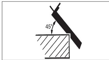
Een snel en eenvoudig afschuiven van kanten met een hoek van 45° wordt mogelijk gemaakt door de V-gleuf voorzien in de voorste grondplaat. De schaaf met de V-gleuf op de te bewerken kant plaatsen en langs deze leiden. Er daarbij op letten dat de schaaf gelijkmatig naar voren wordt geschoven en dezelfde hoek wordt behouden.
