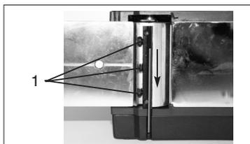
Suelte las tres tuercas hexagonales (1) con la llave de boca que se adjunta y saque la hoja reversible de metal duro del cepillo empujando lateralmente con ayuda de un trozo de madera.
