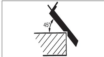
Le biseautage rapide et simple d'arêtes à un angle de 45° est facilité par la rainure en V disposée dans le plateau de base avant. Placez la raboteuse avec la rainure en V sur l'arête à travailler et guidez la raboteuse le long de l'arête en prenant garde à une avance régulière et à une position d'angle constante.
