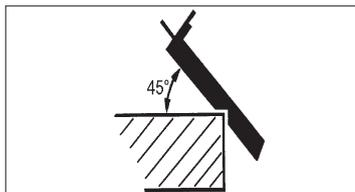
Una smussatura veloce e semplice degli spigoli ad un angolo di 45° viene consentita dalla scanalatura a V della piastra base anteriore. Appoggiate il pialletto con la scanalatura a V sullo spigolo da lavorare e fatelo scorrere su di esso, facendo attenzione che l'avanzamento sia omogeneo e che si mantenga la stessa inclinazione.
