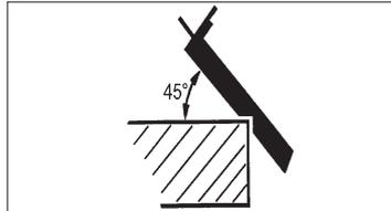
Uma ranhura em V existente na placa de base da frente permite chanfrar de forma rápida e simples arestas com um ângulo de 45°. Coloque a plaina com a ranhura em V na aresta a trabalhar e desloque-a ao longo dela, tendo o cuidado de manter um avanço regular e o mesmo ângulo.
