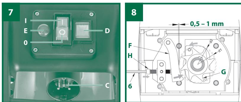
Zum Austausch von Häckselmesser und Gegenmesser kann das Häckselgehäuse geöffnet werden. Gehen Sie dazu wie folgt vor:
