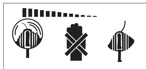
**L'utensile continua a ruotare dopo avere spento il motore!**
