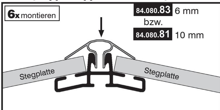
**18/e Profil (Einfachclipp / Dacheckprofil)**
