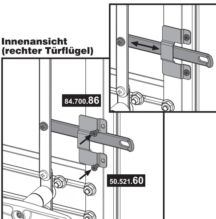
**! Hinweis:** Der seitliche Riegel schiebt sich vor das Türprofil des anderen Türflügels sobald der Griff gedreht wird. Die Tür ist somit verriegelt.
