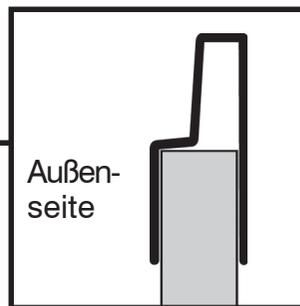
**17/b** An den gleichen Stegplatten werden oben Ausgleichsprofile (Länge 665 mm; 6 mm: Pos. 5; 10 mm: Pos. 10) mittig angebracht. Achten Sie darauf, dass sie richtig herum aufgesteckt werden (vgl. Profilansicht).
