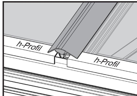
Achten Sie darauf, dass die Doppel-Clips am unteren Ende komplett auf den h-Profilen aufliegen.
