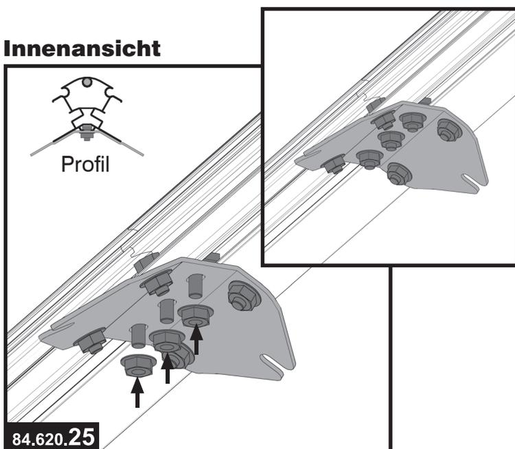
**10/c** Montieren Sie ein Knotenblech Seite an das Verbindungsteil, indem Sie drei Muttern auf die jeweiligen Gewinde des Verbindungsteils drehen. Zusätzlich wird das Knotenblech mit je zwei Schrauben links und rechts am First befestigt. Stecken Sie dazu von außen Schrauben in die entsprechenden Löcher am First und Knotenblech und befestigen sie mit Muttern.
