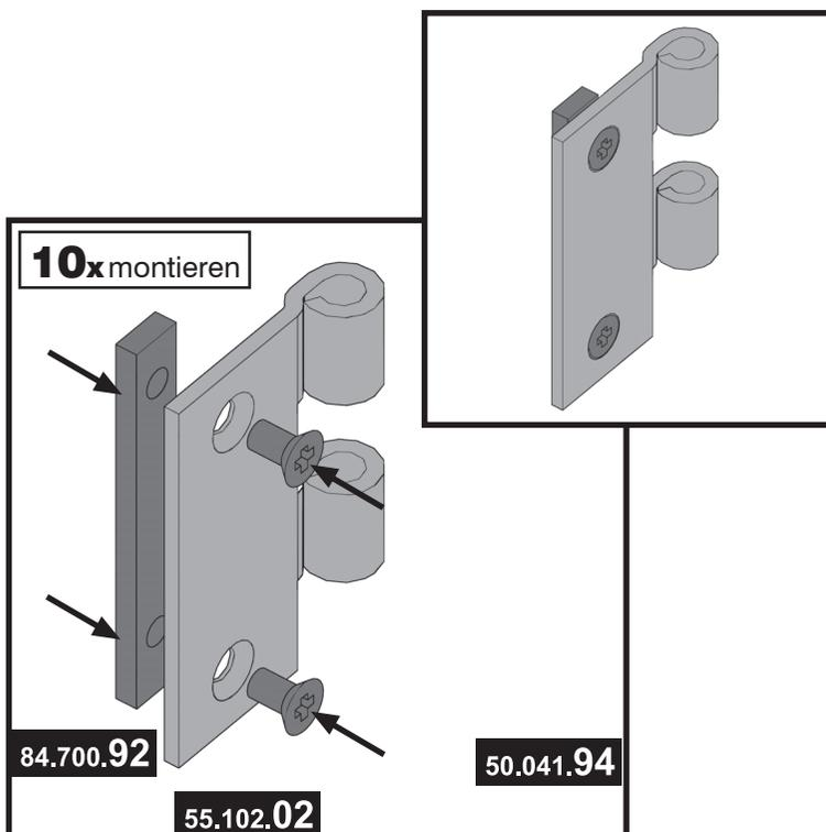
**5/b** Am Scharnierflügel wird eine Scharnierleiste (Pos. 6) mit zwei Senkschrauben (Pos. 3) **locker** befestigt. Achten Sie darauf, dass Sie die Senkschrauben in die dafür vorgesehenen Aussparungen am Scharnierflügel einsetzen (vgl. Abb.).
