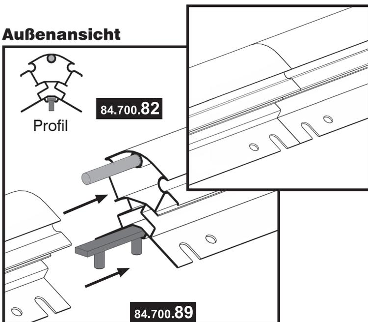
**10/b** Schieben Sie das Verbindungsteil zur Hälfte in die unten liegende Führungsschiene des Firstprofils. Anschließend stecken Sie das zweite Firstprofil auf das Verbindungsteil und den Bolzen.
