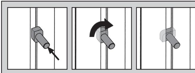
Sollten Sie die Rhombusschrauben nicht problemlos in der Führungsschiene drehen können, lösen Sie gegebenenfalls die Muttern, drehen die Schrauben in die richtige Position und ziehen die Muttern wieder fest.
