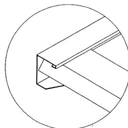
JEDER PERIMETERABFLUSS MUSS MIT DEN BLECHKANTEN BÜNDIG SITZEN. DAS SNAP-TITE SYSTEM ERMÖGLICHT IHNEN EINE EINSTELLUNG FÜR DIESEN VORGANG, INDEM SIE DEN ABFLUSS DIE BLECHE ENTLANGKLOPFEN, BIS JEDES ENDE BEQUEM BÜNDIG SITZT.
