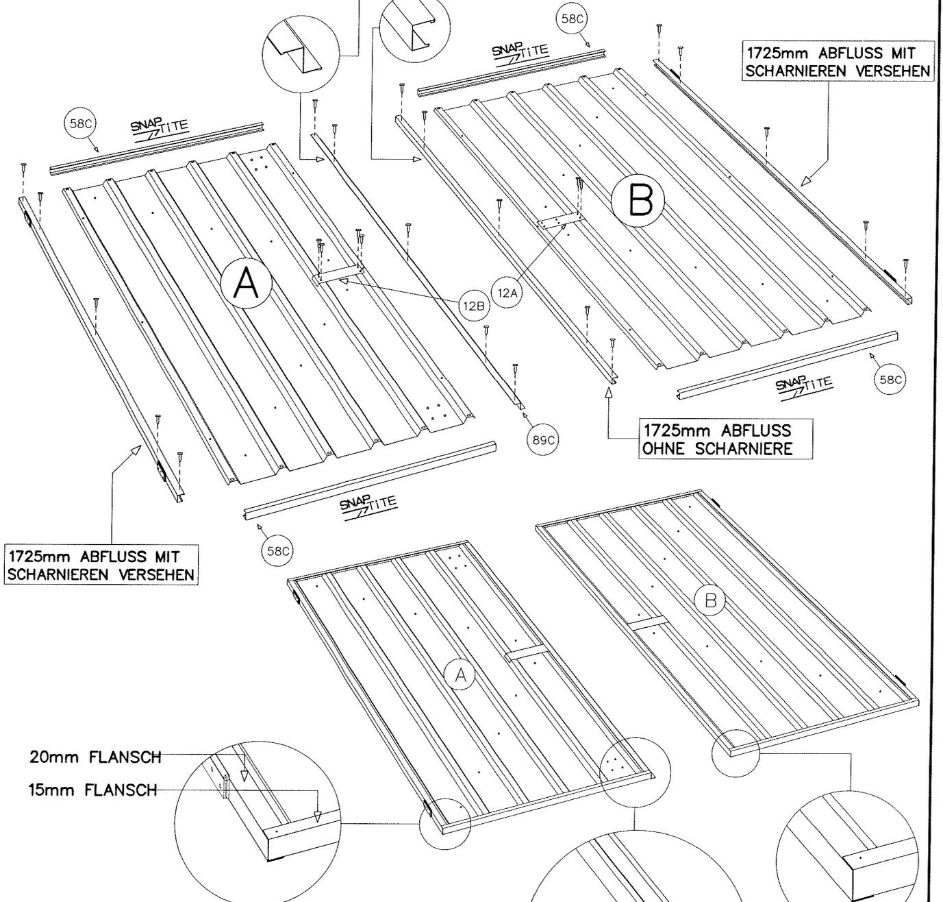
BEACHTEN SIE, DASS DIE OBIGEN BESTANDTEILE MIT TEILNUMMERN NICHT MARKIERT WURDEN, DAMIT DER ÄUSSERE ANBLICK DER SCHUPPENVORDERSEITE NICHT BEEINTRÄCHTIGT WERDE. DIESE BESTANDTEILE KÖNNEN LEICHT IDENTIFIZIERT WERDEN, INDEM MAN DIE LÄNGE JEDES BESTANDTEILS ÜBERPRÜFT UND SIE MIT DEN ANGEGEBENEN GRÖSSEN VERGLEICHT.
