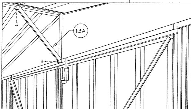
NACHDEM SIE BEIDE DACHTAFELN AN DIE WÄNDE WIE OBEN ABGEBILDET BEFESTIGT HABEN, PASSEN SIE EINE REGENT-STREBE IN DEN FIRSTBALKEN UND IN DIE VORDERWAND WIE OBEN ABGEBILDET HINEIN, SIE WERDEN DIE SCHON BESTEHENDEN SCHRAUBEN AN FIXIERPUNKTEN ENTFERNEN UND ERSETZEN MÜSSEN.
