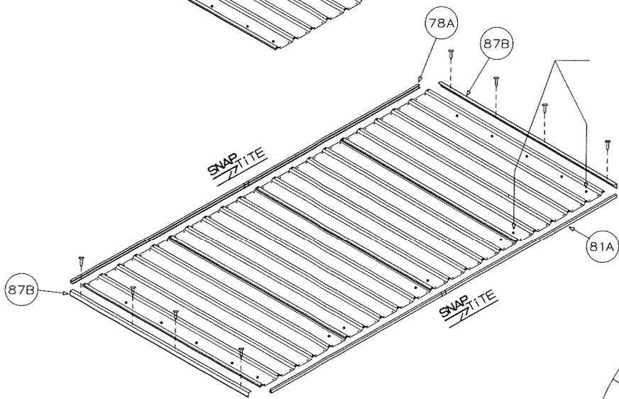
2 VORGESTANZTE LÖCHER AN DIESEM ENDE JEDES BLECHES MIT TEIL 81A MONTIERT.
