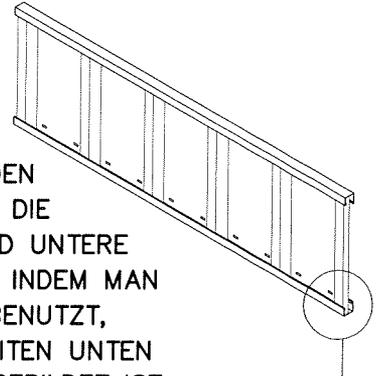
UM DIE VIER WANDTAFELN UND DIE BEIDEN DACHTAFELN VORZUMONTIEREN, WERDEN DIE PERIMETERABFLÜSSE AN DAS OBERE UND UNTERE ENDE DER JEWEILIGEN TAFEL BEFESTIGT, INDEM MAN DAS SNAP-TITE BEFESTIGUNGSSYSTEM BENUTZT, UND ZWAR WIE AUF DEN FOLGENDEN SEITEN UNTEN DEM
