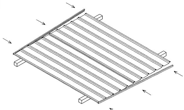
NACHDEM SIE DIE BLECHE VERBUNDEN HABEN, BRINGEN SIE DEN RICHTIGEN PERIMETERABFLUSS AN EINEM ENDE DER BLECHE AN, INDEM SIE IHN MIT LEICHTEM SCHLAG ÜBER DIE SNAP-TITE-ANSÄTZE KLOPFEN, UND DIE BLECHE ENTLANGARBEITEN, BIS SIE DAS ANDERE ENDE ERREICHEN. SIE KÖNNEN DEN ABFLUSS ÜBER DIE ANSÄTZE MIT DER HAND ODER MIT EINEM WEICHEN STÜCK HOLZ ODER MIT EINEM GUMMIHAMMER KLOPFEN. PFÜFEN SIE ZWEIMAL NACH, DASS JEDER SNAP-TITE ANSATZ IN DEN ABFLUSS VERSCHLOSSEN IST.
