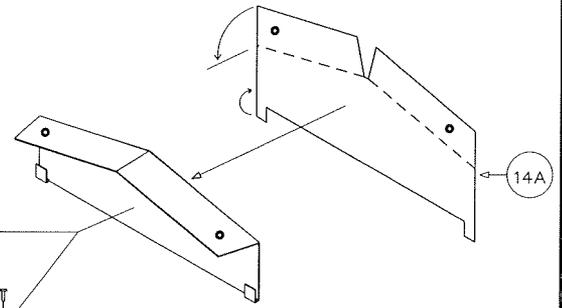
BEIGEN SIE DIE OBEREN UND UNTEREN FLANSCH, WIE ABGEBILDET. HAKEN SIE DANN DIE UNTEREN FLANSCH UNTER DIE DACHENDE-ABDECKBLECHE UND SCHRAUBEN SIE DIE OBEREN FLANSCH WIE ABGEBILDET FÜR BEIDE GIEBELKAPPEN.
