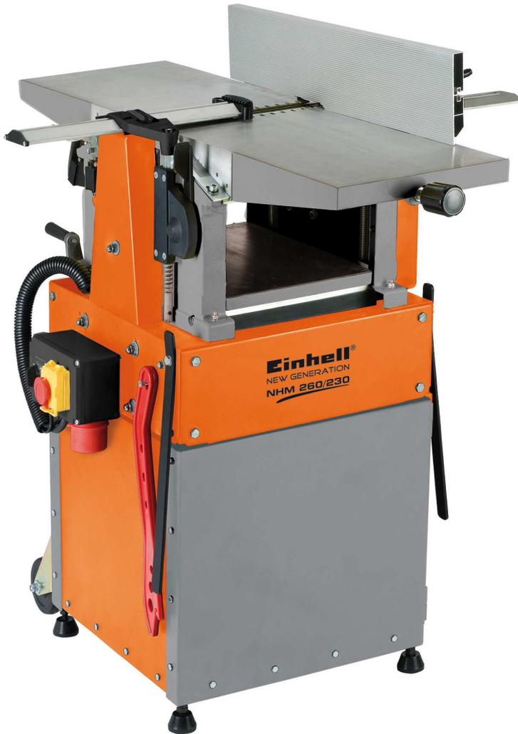
Die Abricht- und Dickenhobelmaschine NHM 260/230 ist eine Maschine für hohe Ansprüche an Genauigkeit und Präzision im angemessenen Größenbereich. Die NHM 260/230 bietet universelle Bearbeitungsmöglichkeiten, beispielsweise rohe Hölzer winklig und plan abrichten oder im Dickentisch maßgenau auf Dicke hobeln. Der Fügeanschlag ist horizontal verstellbar und kann zum Fasen um 45° geneigt werden.
