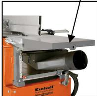
Stufenlos verstellbarer Parallelanschlag für exaktes Arbeiten
