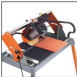
stufenlos schwenkbare Motorführung von 0°-45°
