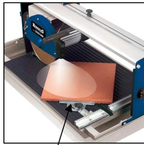
gradgenau einstellbarer Winkelanschlag für exakte Schnitte
