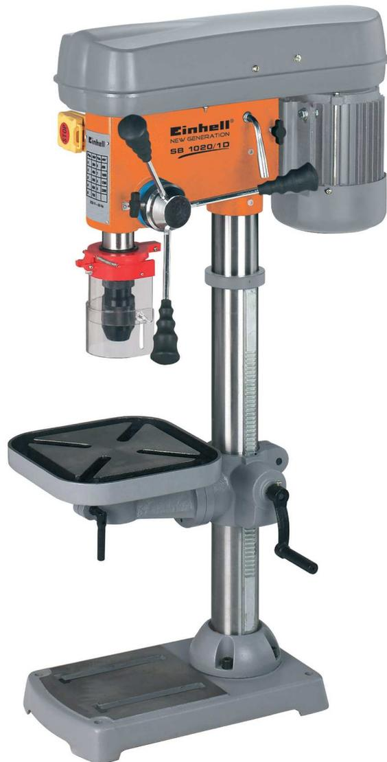
Die Säulenbohrmaschine SB 1020/1 D ist ausgestattet mit Keilriemenantrieb, einem stufenlos in der Höhe verstellbaren, neigbaren und seitlich ausschwenkbarem Bohrtisch, einer kugelgelagerten Bohrspindel, einem einstellbaren Tiefenanschlag, einem Ein-Aus-Schalter mit Nullspannungsauslösung, einem Kontaktschalter im Keilriemengehäuse und einem klappbaren Späneschutz.
