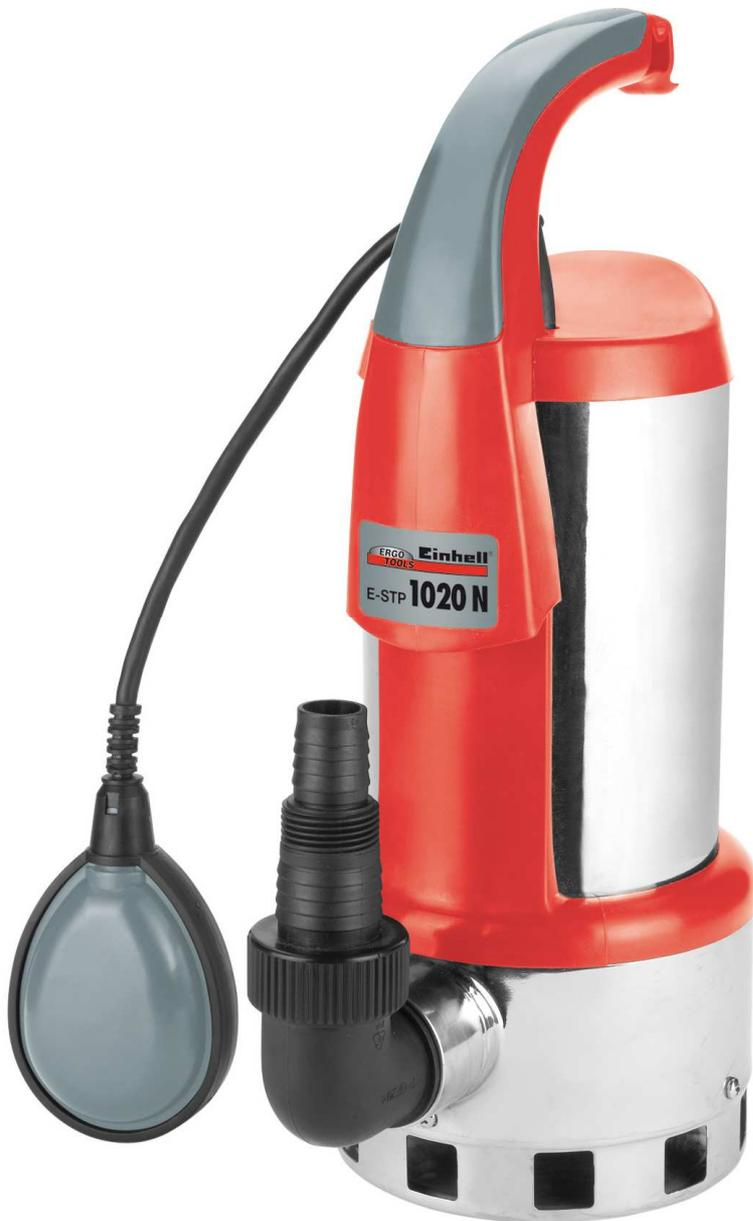
Die robuste und leistungsstarke Schmutzwasser-Tauchpumpe eignet sich besonders zum Bewegen von verunreinigtem Wasser. Verunreinigungen mit einem Durchmesser bis zu 20 mm stellen für diese Pumpe keinerlei Problem dar. Neben ihrem typischen Einsatzgebiet in Baugruben, eignet sich diese Pumpe ideal zum Entleeren von Gartenteichen oder Swimmingpools. **Durch ihren stufenlos höhenverstellbaren Schwimmerschalter ist die Pumpe unentbehrlich bei Überschwemmungen oder Wasserrohrbrüchen.**
