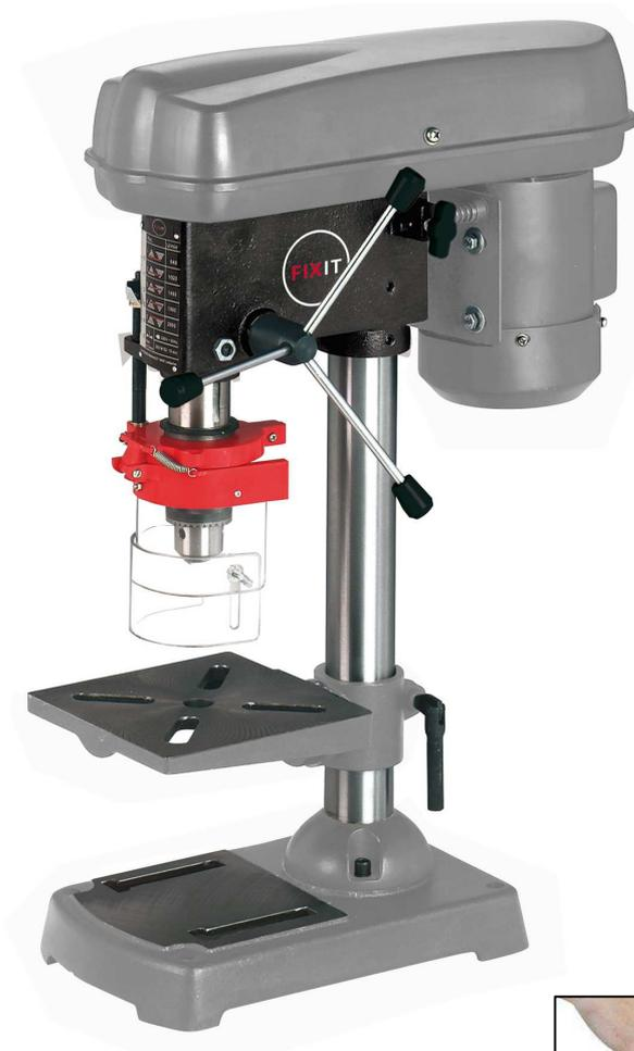
Die Säulenbohrmaschine SB 401/1 ist ausgestattet mit Keilriemenantrieb, einem stufenlos in der Höhe verstellbaren, neigbaren und seitlich ausschwenkbarem Bohrtisch, einer kugelgelagerten Bohrspindel, einem Ein-Aus-Schalter mit Nullspannungsauslösung, einem Kontaktschalter im Keilriemengehäuse, einem klappbarem Späneschutz und einem Tiefenanschlag.
