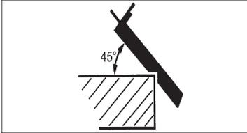
Ein schnelles und einfaches Anfasen von Kanten im 45° Winkel wird durch die in der vorderen Grundplatte eingearbeitete V-Nut ermöglicht. Den Hobel mit der V-Nut auf die zu bearbeitende Kante aufsetzen und an dieser entlang führen, dabei ist auf einen gleichmäßigen Vorschub und auf eine konstante Winkellage zu achten.
