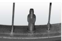
Ventilul adaptor facilitează o umflare ușoară a roților de bicicletă.
