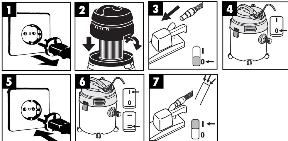
Ⓓ Schliessen Sie das Elektrowerkzeug an die Einbausteckdose an. Schalten Sie den Ein/Ausschalter des Staubsaugers auf Position 1 (Bild 6) und den Automatikschalter auf Position 2. Sobald Sie das Elektrowerkzeug einschalten, schaltet sich der Staubsauger ein (Bild 7). Wenn Sie Ihr Elektrowerkzeug ausschalten, schaltet sich der Staubsauger mit einer voreingestellten Verzögerung aus.
