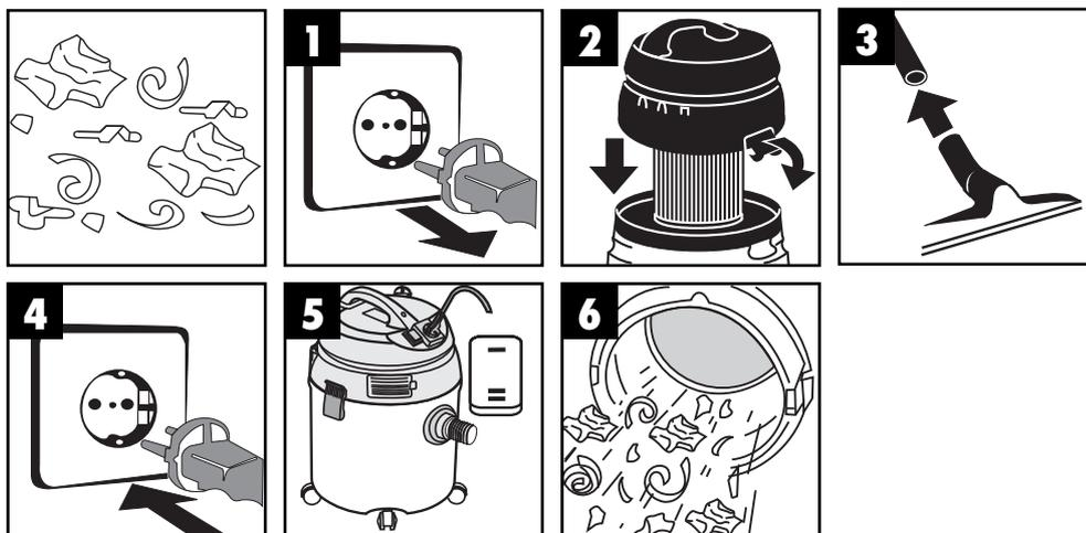
Ⓓ Zum Trockensaugen schieben Sie den Faltenfilter (Bild 2) auf den Filterkorb. Der Faltenfilter ist nur für das Trockensaugen geeignet!
