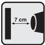
Der Düsenausgang muss mind. 7 cm vom zu bearbeitenden Werkstück entfernt sein, da der entstehende Luftstau zu einer Beschädigung des Gerätes führen kann.
