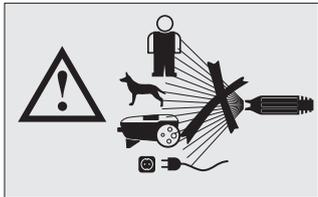
Ⓢ **Warnung!** Hochdruckstrahlen können bei unsachgemäßem Gebrauch gefährlich sein. Der Strahl darf nicht auf Personen, Tiere, aktive elektrische Ausrüstung oder auf das Gerät selbst gerichtet werden.
