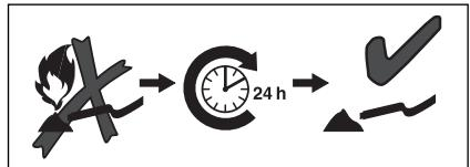
Antes de aspirar estufas y fogones, espere al menos 24 horas para asegurarse que se ha enfriado y que el fuego se ha extinguido completamente. ¡Sólo para cenizas frías, ver manual de instrucciones!
