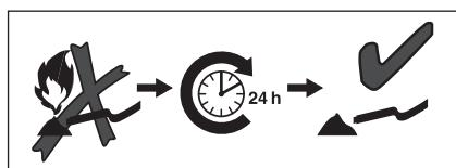
Warten Sie mit dem Aussaugen von Öfen und Feuerstellen mindestens 24 Stunden, so dass das Feuer sicher erloschen und abgekühlt ist. Nur für kalte Asche, siehe Bedienungsanleitung!
